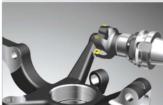
Фрезерование торца (фреза типа Future Mill)
