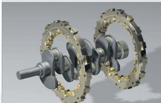
Внутреннее и внешнее фрезерование шеек коленчатого вала
