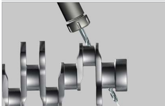
Сверление отверстия под штифт (сверла MLD)
