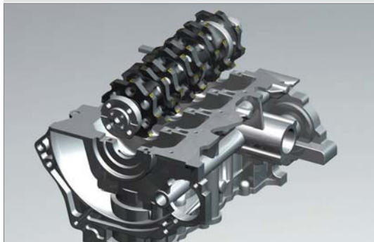
Фрезерование внутренних плоскостей набором фрез
