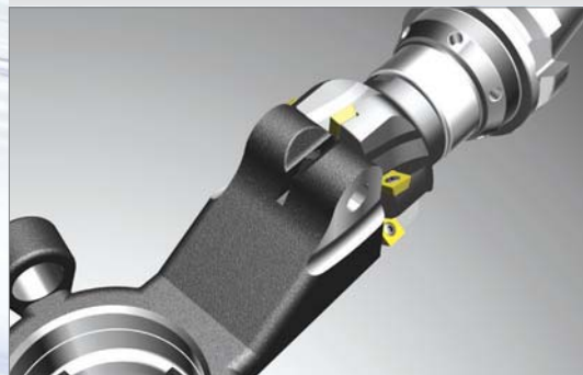
Фрезерование торца (фреза типа Future Mill)
