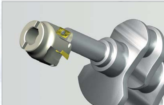
Обработка торца цапфы (фреза серии Alpha Mill)
