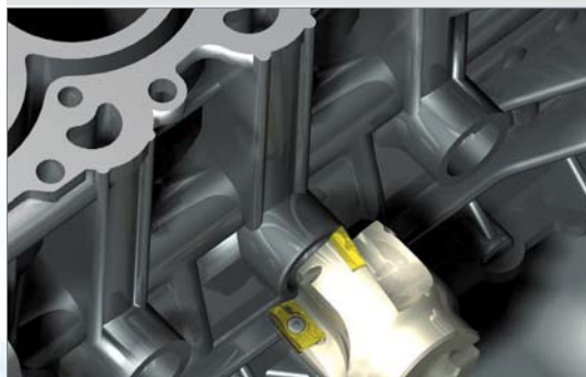
Фрезерование боковых плоскостей (фреза типа Alpha Mill)
