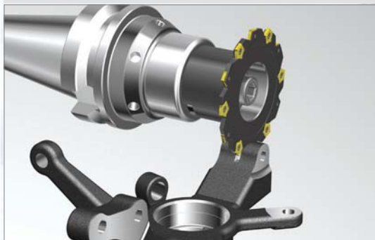
Фрезерование паза (прорезная фреза типа SPB)
