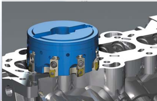
Черновая и чистовая обработка верхней плоскости (фрезы серии Aero Mill)
